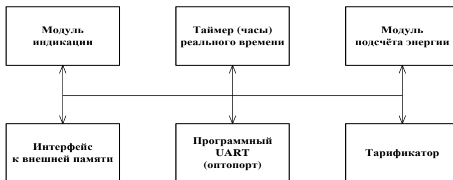
Рисунок 3 - Структура программного обеспечения «Меркурий 206»
