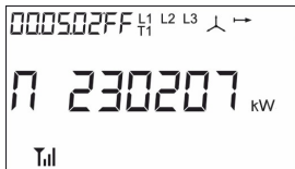
Рис. 20 Меню 12 кадр 9. Начальный кадр подгруппы. Лимит Энергии. Режим работы – лимит за расчетный период (месяц).
