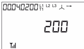
Рис. 21 Меню 12 кадр 11. Начальный кадр подгруппы. Коэффициент трансформации по току. (для счётчиков трансформаторного подключения)
